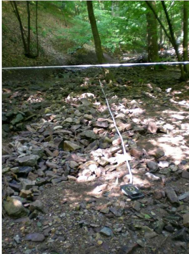
**Figure 5-31 : Granulométrie Wolman réalisée dans le secteur aval du ruisseau du Blanc Gravier (source : LHGF)**
